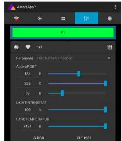
Die Lampe arbeitet mit der Dynamic Power Boost Funktion. Diese Funktion gewährleistet, dass Farben, die weniger Energie benötigen, leicht verstärkt werden, während leistungsintensive Farben etwas reduziert werden.
