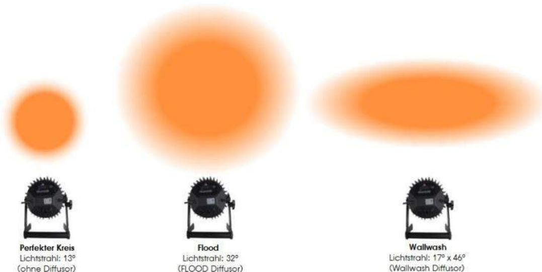
**HINWEIS:** Die Art/Bezeichnung des Filters ist an der Kante eingepreßt (FLOOD oder WALLWASH).
